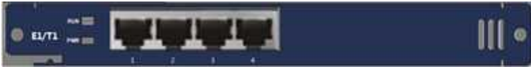
图 1-6 IAD100-8E1 4E1/T1 数字中继板外观图
