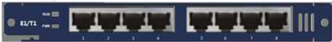
图 1-5 IAD100-8E1 8E1/T1 数字中继板外观图
