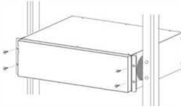
图 2-2 安装设备到机柜中
