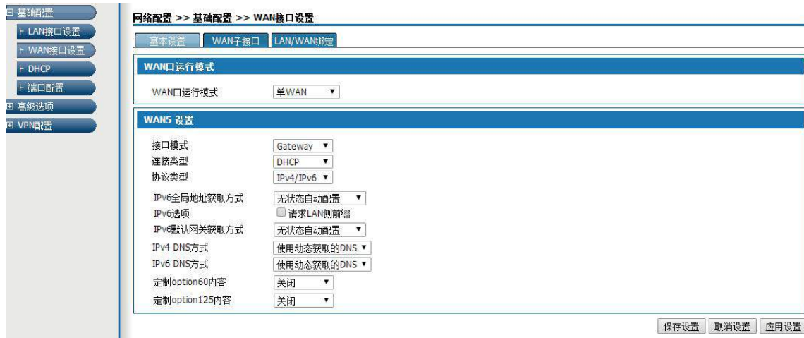
图 5-5DHCP 方式获取 IP 地址
