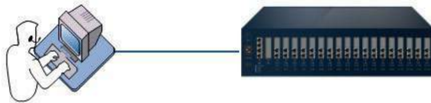
图 3-1 连接 IP PBX 和终端 PC
