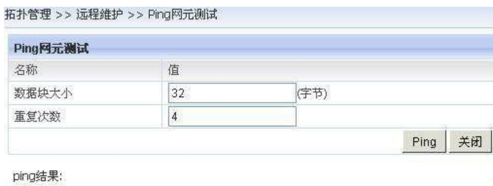
图 6-38 网元远程维护-Ping 网元测试
