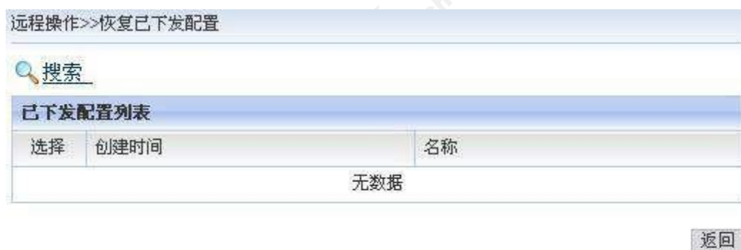
图 6-30 网元远程操作-恢复设备已备份配置
